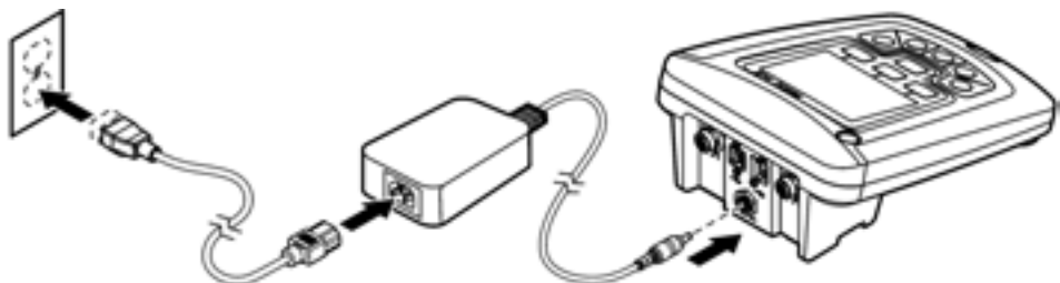
Рисунок 3 Подключение к сети переменного тока
